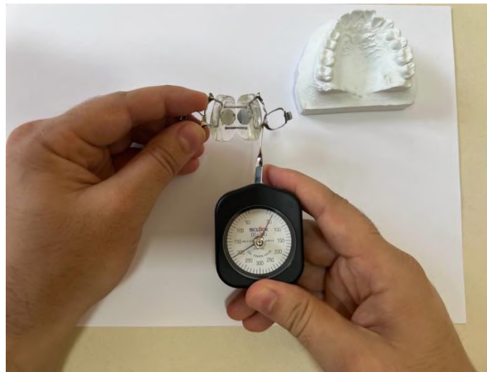
Рис. 5. Методика измерение силы расширяющего винта или магнита.
