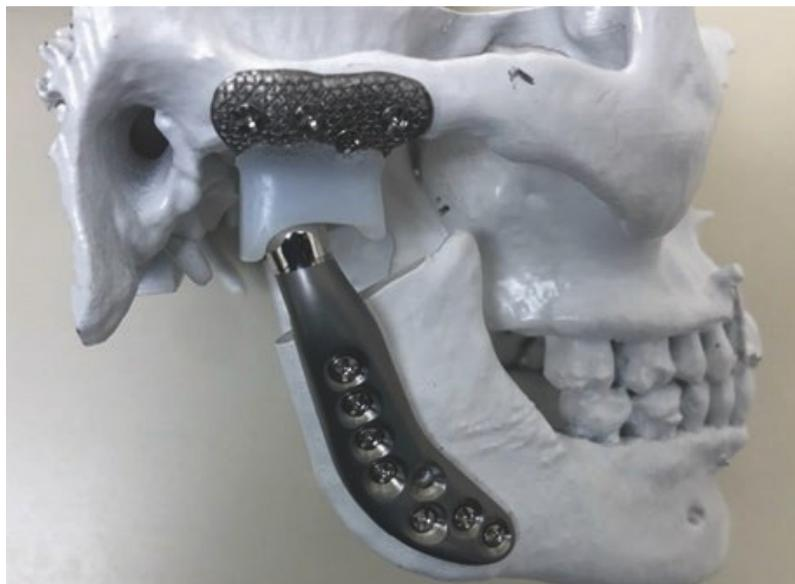
**Рис. 3. Индивидуальный височно-нижнечелюстной протез. Концептуальный протез с головкой мыщелка из сплава Co-Cr-Mo и титановая сетка + компонент ямки из UHMWPE**
